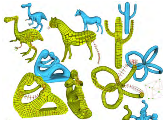
Génération de maillages hexaédriques pour des surfaces dont la forme peut être représentée par leur squelette
